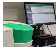
Quantifizierung der Genfragmente mittels Droplet-Reader und Analyse-Software für die digitale PCR
